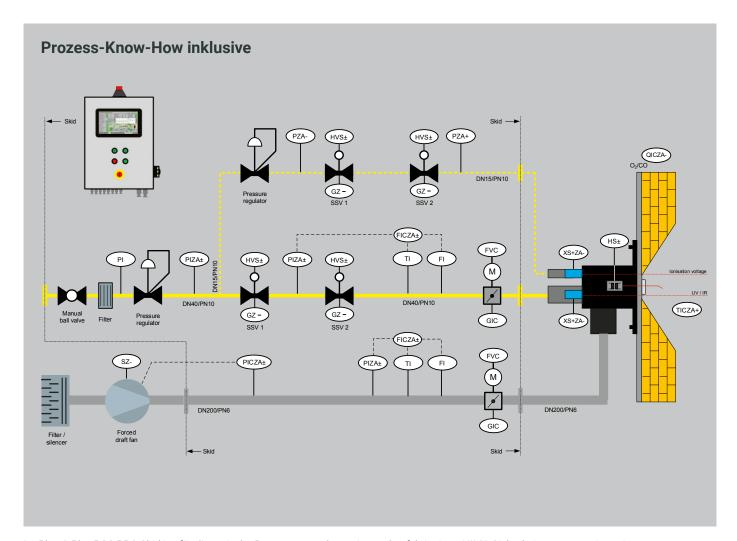
$Im\ Plug\ \&\ Play\ BCS\ PRO\ Skid\ ist,\ f\"{u}r\ die\ typische\ Brenneranwendung,\ eine\ vorkonfektionierte\ HIMA\ Sicherheitssteuerung\ integriert$
